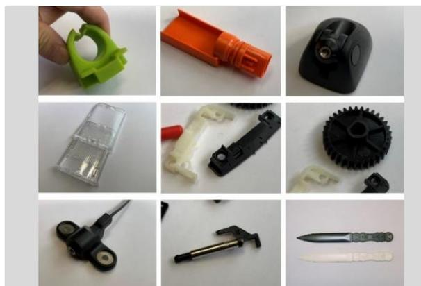
**試作用金型を使用して樹脂部品を短納期
